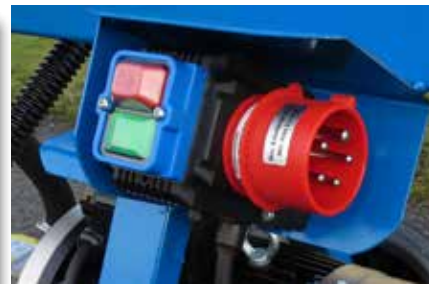
Motorskydd med fasväxlare 3-fas 400 V
